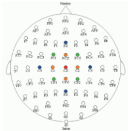
FIGURE A.1 – Trois filtres laplaciens appliqués à l'électrode Cz (rouge). La moyenne des signaux mesurés en C3 , C4 , Fz et Pz (bleu) est retirée au canal Cz (rouge) pour le filtre laplacien large. Les électrodes utilisées pour un filtre laplacien moyen et étroit sont représentées en vert et orange respectivement.
