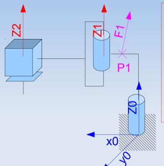
On applique au point P1 lié à R1 une force F1. forces généralisées exercés sur les actionneurs ? réponse :
