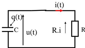
à l'instant  $t=0$  le condensateur est chargé  $u(0) \neq 0$ , il porte la charge  $q(0) = C.u(0)$  on ferme l'interrupteur  $k$  et le courant commence à passer.
