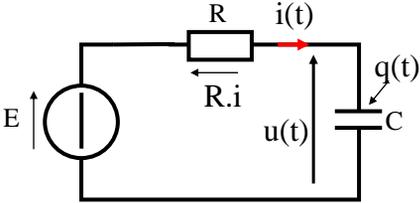
à l'instant  $t=0$  le condensateur est déchargé  $u(0)=0$ , et  $q(0)=0$ . on ferme l'interrupteur  $k$  et le courant commence à passer.
