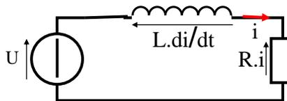
à l'instant  $t=0$ , on ferme l'interrupteur  $k$  et le courant commence à passer.  $i(0)=0$ .
