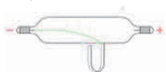
L'aimant dévie le rayon cathodique: Ce n'est pas un rayonnement lumineux
